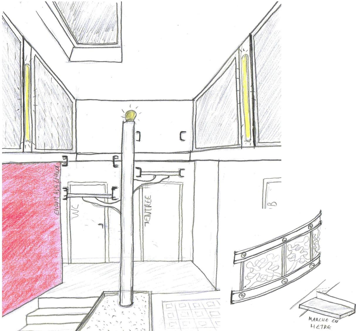
Il s'agit d'une petite villa des années 1950 que le propriétaire souhaite isoler tout en rendant les combles utilisables à moindres frais. L'intervention consiste donc à remplacer les fenêtres, isoler le soubassement et la toiture tout en ajoutant un escalier permettant l'accès aux combles. Paré de nombreux velux ce nouvel espace est destiné à la salle de jeux des enfants et à divers rangements. Une trouée et un réaménagement du hall permettent l'insertion d'un escalier bois-métal.
