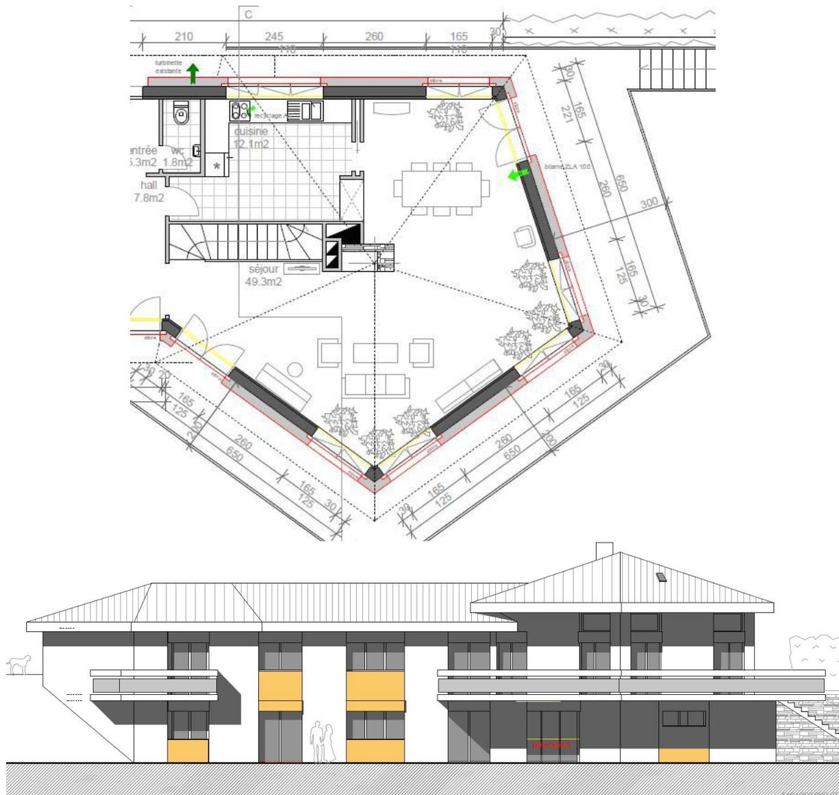
Projet d'isolation d'une maison des années 1970 sans trahir l'architecture d'origine. Triple vitrage, isolation en laine de bois, isolation sur dalle des combles, caissons de stores rapportés et nouveau système de ventilation sont nécessaires pour améliorer significativement les performances énergétiques de ce bâtiment.
